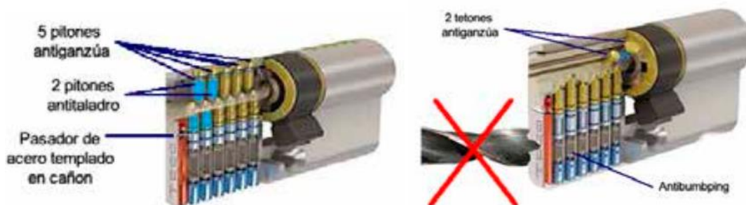
Figura 17. Mecanismo antitaladro y mecanismo antiganzúa. Fuente: CEIS Guadalajara
